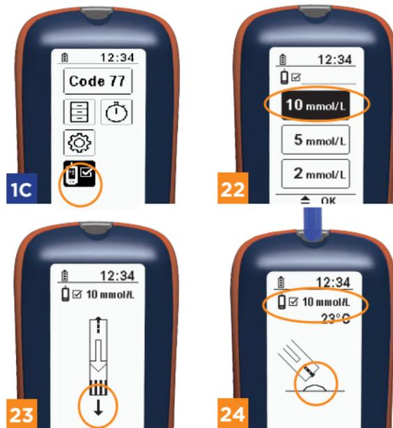
Geben Sie einen Tropfen der Check Solution aus und werfen Sie ihn. Geben Sie einen zweiten Tropfen Check Solution auf eine nicht saugfähige Oberfläche (z. B. Kunststoff- oder Aluminiumfolie) und halten Sie das Messgerät mit dem eingelegten Teststreifen zum Tropfen. Warten Sie, bis der Tropfen die Messkammer gefüllt hat. Ein Signalton weist darauf hin, wenn die Messkammer ausreichend gefüllt ist.
